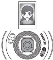
Cuando deslice el "Interruptor de viñeta manual", las láminas del interior del objetivo sobresaldrán. La función de viñeta se aplicará disparando tal cual.
