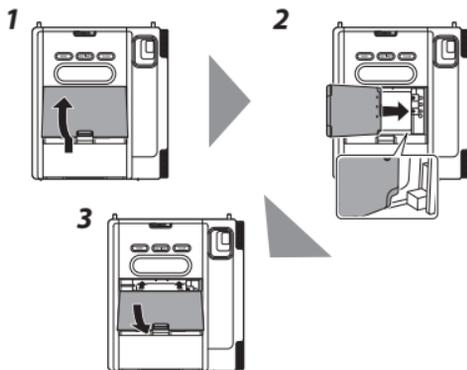
배터리 커버 잠금장치를 밀어 올려 배터리 커버를 탈거합니다. 배터리를 카메라 형태와 단자 위치에 맞추고 배터리를 왼쪽에서 오른쪽으로 밀어 장착하고 덮개를 닫습니다.
