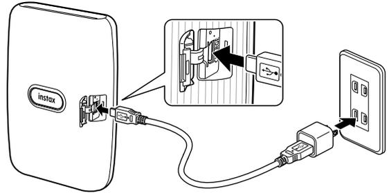
プリンターとご使用のスマートフォンなどのUSB電源アダプタを、付属のUSBケーブルで接続し、USB電源アダプタを屋内のコンセントにつなぎます。
