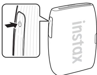
Mantenha o botão de alimentação pressionado durante aproximadamente 1 segundo para ligar ou desligar a impressora. O LED acende-se quando a impressora é ligada. A impressora desliga-se automaticamente quando não é utilizada durante um determinado período de tempo.
