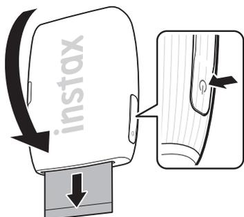
Pode imprimir novamente a imagem que foi impressa imediatamente antes de desligar a impressora. Vire a impressora com a ranhura de ejeção do filme voltada para baixo e pressione o botão de alimentação.
