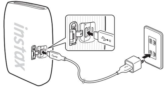
Ligue a impressora com o cabo USB Type-C fornecido a um adaptador USB CA (fornecido com o seu smartphone) e, em seguida, ligue o adaptador USB CA a uma tomada interior.
