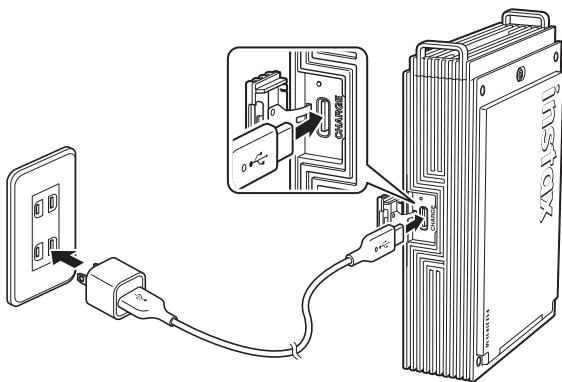
Chargez l'imprimante en branchant le câble USB de type-C fourni sur une prise USB, ou branchez le câble USB de type-C sur un adaptateur secteur USB (adaptateur vendu séparément) et chargez l'appareil sur une prise d'alimentation électrique. Aucun adaptateur secteur USB n'est fourni avec l'imprimante instax mini Link+<sup>MC</sup>.
