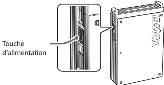
Maintenez la touche d'alimentation enfoncée pendant environ 1 seconde pour mettre l'imprimante sous ou hors tension. Une DEL s'allume lorsque l'imprimante est sous tension. L'imprimante s'éteint automatiquement lorsqu'elle n'est pas utilisée pendant un certain temps (la fonction d'arrêt automatique peut être réglée dans l'application instax mini Link<sup>MC</sup>).
