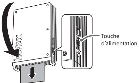
La dernière image imprimée peut être réimprimée en retournant l'imprimante avec la fente d'éjection du film dirigée vers le bas et en appuyant sur la touche d'alimentation.
