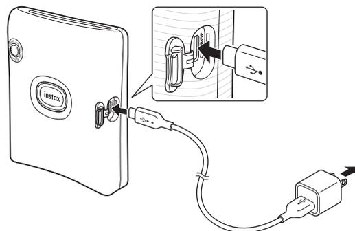
Ligue a impressora utilizando o cabo USB de tipo C fornecido a um adaptador USB CA (fornecido com o seu smartphone) e, em seguida, ligue o adaptador USB CA a uma fonte de alimentação interior.
