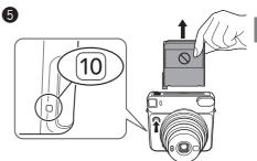
シャッターボタンを押します。 フィルムカバー(黒色)が排出され、カメラ背面に あるフィルムカウンターに「10」が表示されます。
