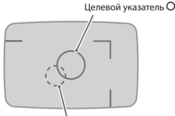
Данный целевой указатель
